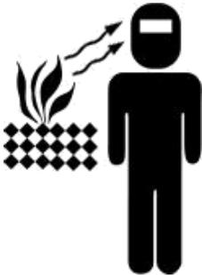
Lichtbogenstrahlung **kann verbrennen:** Es ist nicht erlaubt, einen Schweißlichtbogen mit ungeschützten Augen direkt zu beobachten. Der Lichtbogen und die beim Betrieb entstehenden Spritzer können die Haut verbrennen oder eine Flamme verursachen, deshalb muss immer eine Schutzmaske mit einem getönten Filter getragen werden (Schutzbrille muss mit einem Glas mit einem Filter der Stufe DIN 9 10 ausgestattet sein).
