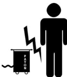
**ELEKTRISCHE STROMVERSORGUNG:** Arbeiten Sie nicht mit beschädigten Schweißkabeln oder auf nassem Boden. Schweißkabel müssen stark, unbeschädigt und isoliert sein. Geschwächte Verbindungen und beschädigte Kabel müssen sofort ausgetauscht werden. Bewegen Sie die Maschine nicht durch Ziehen am Netzkabel oder an den Schweißkabeln. Führen Sie keine Wartungsarbeiten an der Maschine durch, während sie in Betrieb ist.
