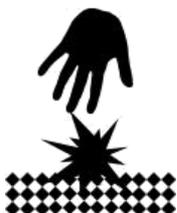
**GESCHWEISSTE MATERIALIEN KÖNNEN BRANDEN:** Berühren Sie geschweißte Teile unter keinen Umständen mit bloßen Händen. Tragen Sie bei der Bedienung der Maschine immer Schutzhandschuhe. Der Lichtbogen und die Spritzer des Stroms können Hautverbrennungen verursachen. Tragen Sie Schutzhandschuhe und eine Zange, wenn Sie das geschweißte Teil berühren oder bewegen.
