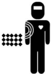
**ELEKTROMAGNETISCHES FELD KANN GEFÄHRLICH SEIN:** Das elektromagnetische Feld, das durch die Hochspannungselektrizität, die durch die Schweißkabel fließt, erzeugt wird, kann die Leistung elektrischer Geräte, wie z. B. **eines Kardiostimulators**, beeinträchtigen. Personen, die eine solche Ausrüstung tragen, sollten einen Arzt aufsuchen, bevor sie einen Bereich betreten, in dem Schweißarbeiten durchgeführt werden. Schweißkabel sollten parallel und möglichst dicht beieinander verlegt werden.
