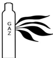
**Zylinder kann explodieren:** Verwenden Sie nur zugelassene Zylinder und ordnungsgemäß funktionierende Druckregler. Der Zylinder sollte in aufrechter Position transportiert und aufgestellt werden. Schützen Sie den Zylinder vor Hitze, Kippen und mechanischer Beschädigung.
